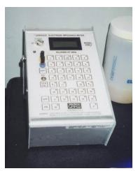
Figure 2: Impedance Meter
